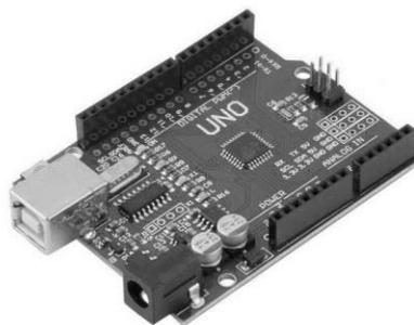
**Figura 50.** Placa *Arduino UNO* com microcontrolador *ATmega328*.
