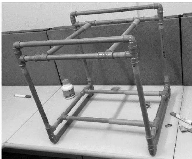
**Figura 47.** Estrutura de PVC da impressora.
