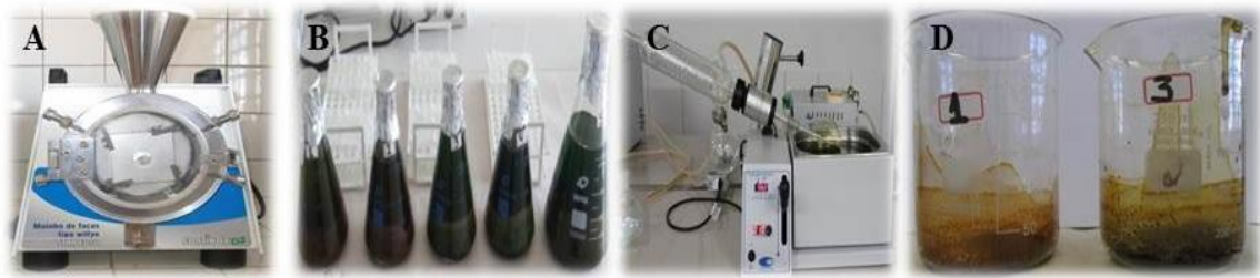
Figura 2: Processo de preparo dos extratos metanólicos. A) Moinho de facas; B) Maceração a frio; C) Extração no evaporador rotativo; D) Extrato metanólico. Morrinhos-GO, 2017.
