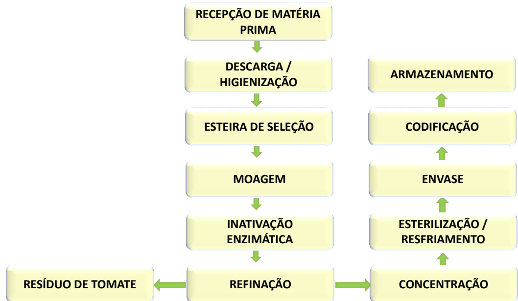
Figura 2 – Fluxograma do Processamento de Polpa de Tomate
