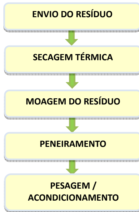
Figura 4 – Fluxograma de processamento da farinha em processo industrial.
