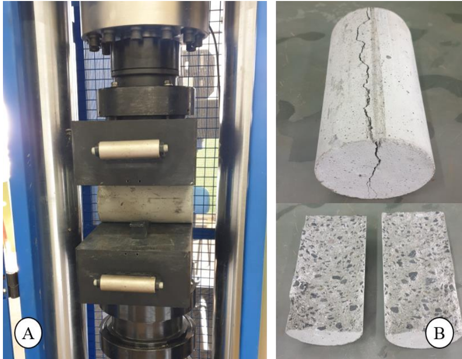
Figura 13 - Ensaio de Tração na Compressão Diametral. A) Aplicação da carga; B) Ruptura do (CP).
