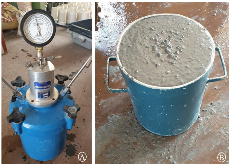
Figura 11 - Ensaio no estado fresco. A) Ar incorporado; B) Massa específica do (CAA). Fonte: Autor (2020).
