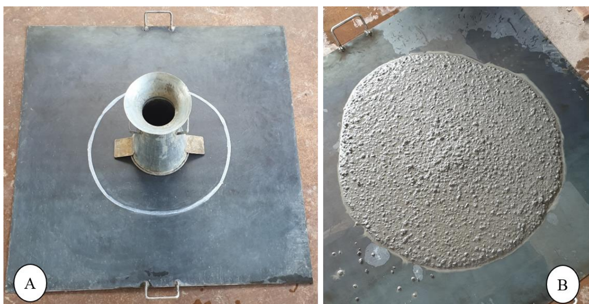
Figura 7 - Ensaio do Tronco de Abrams. A) Aparatos para realização do ensaio; B) Ensaio de espalhamento.
