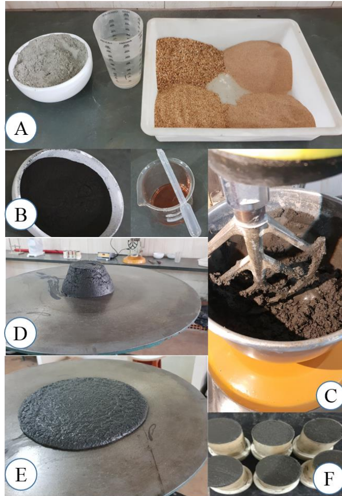
Figura 5 - Realização do ensaio de (IAP). A) Materiais para a Argamassa A; B) Complemento dos materiais para a Argamassa B; C) homogeneização dos materiais na elaboração das argamassas; D e E) Ensaio de índice de consistência; F) Moldagem dos (CP). Fonte: Autor (2020).
