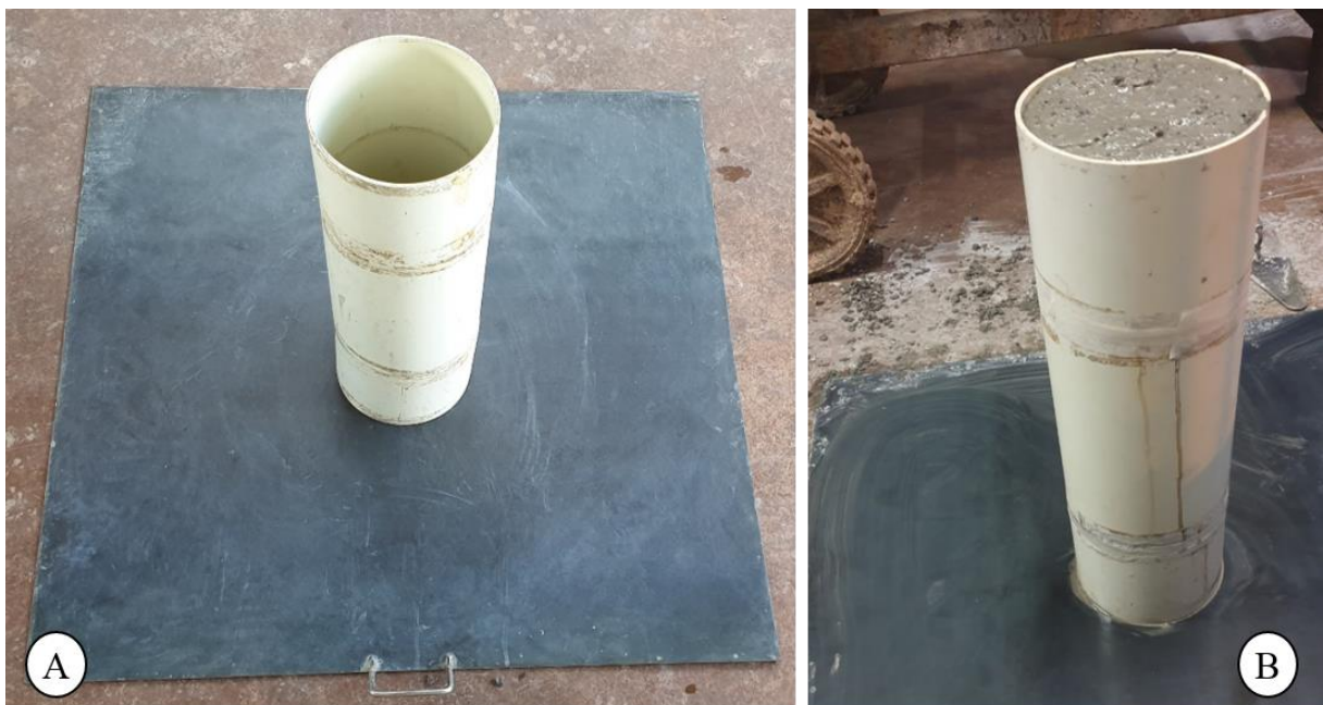
Figura 10 - Ensaio da Coluna de Segregação. A) Aparatos para realização do ensaio; B) Ensaio. Fonte: Autor (2020).
