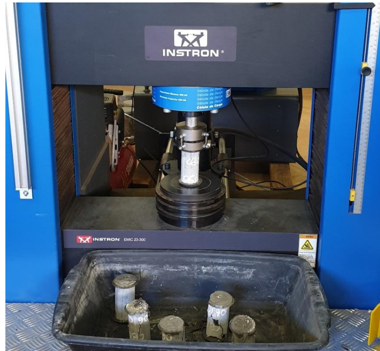
Figura 6 - Ensaio de Compressão Direta. Fonte: Autor (2020).
