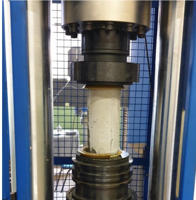
Figura 12 - Ensaio de Compressão Direta. Fonte: Autor (2020).
