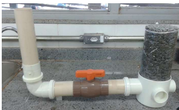
Figura 7 – Aparato de medição de permeabilidade em concretos permeáveis. Fonte: Autor (2020).
