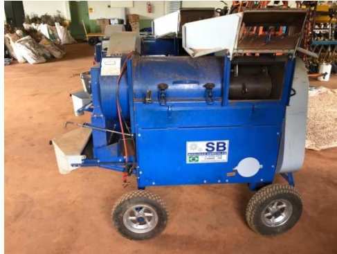
Figura 10. Equipamento utilizado para trilhagem dos grãos (trilhadeira).
