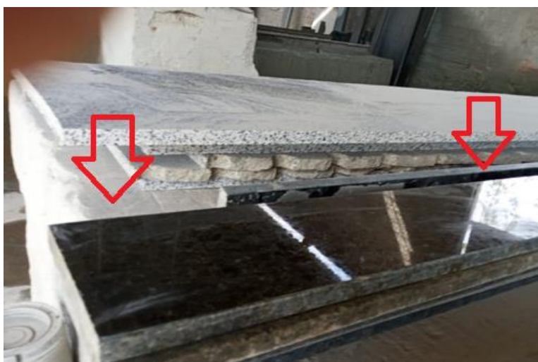
Figura 27 - Soleira acabada e com lustre.
