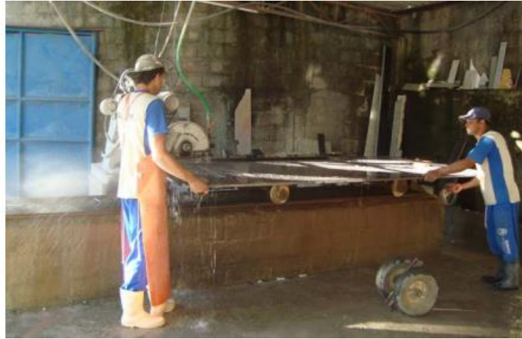
Figura 10 - Corte da chapa de granito em serra-mármore.
