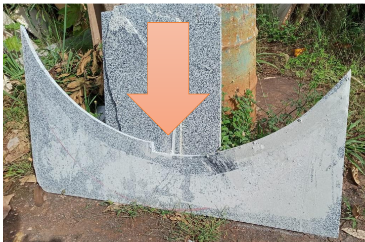
Figura 52 - Resíduos gerados no corte de um balcão com curva arredondada.
