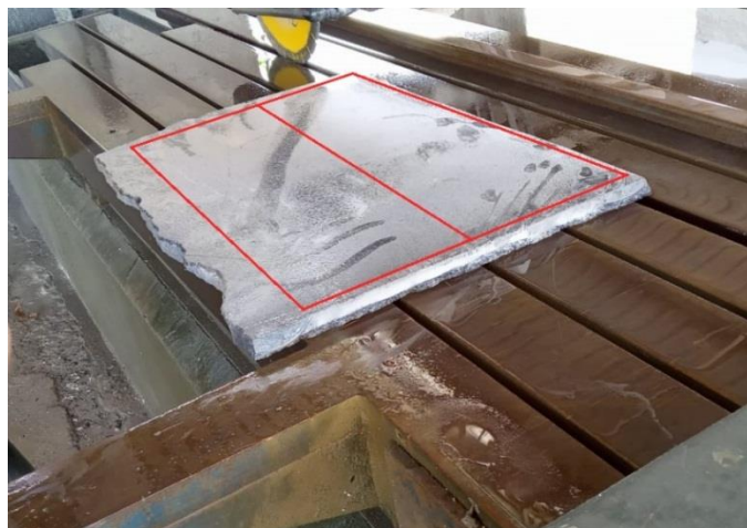
Figura 24 - Corte bruto de uma soleira.
