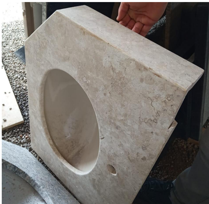
Figura 48 - Lavatório com quebra-de-canto finalizado. Fonte: Autor (2019).
