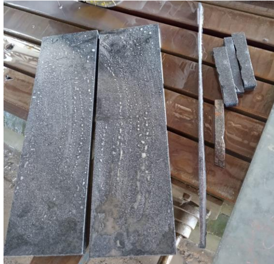
Figura 25 - Resíduos gerados no corte da soleira Fonte: Autor (2019).
