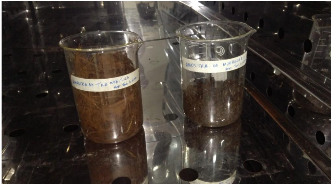
Figura 11 - (a) e (b) Pesagem das amostras, (c) Amostras na estufa, Termofílica (esquerda) e Vermicompostagem (direita).
