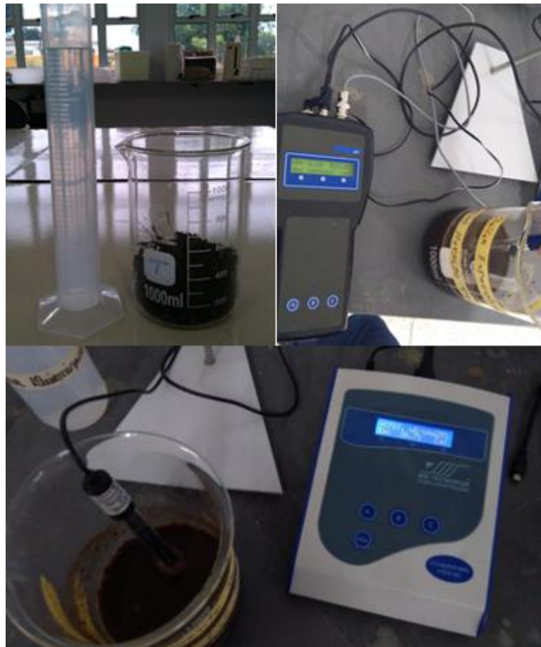
Figura 14 - (a) solubilização das amostras, (b) ensaio de pH e (c) ensaio de condutividade elétrica.
