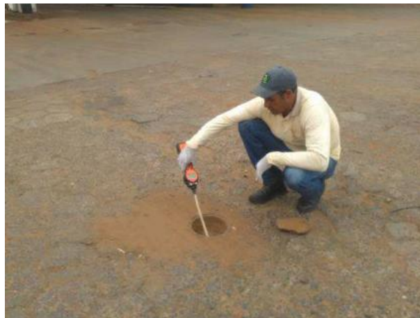
Figura 16: Poço para monitoramento de lençol freático e a vapor.
