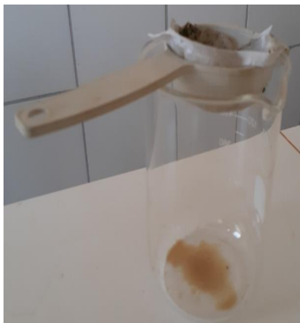
Figura 3. Filtragem do extrato de erva-de-santa-maria em papel toalha sobre uma peneira de plástico de 5 cm de diâmetro no béquer de vidro de 450 mL.
