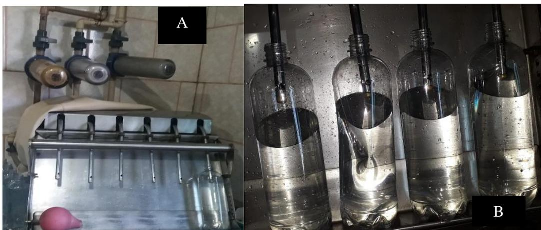
**Figura 11:** Engarrafadora de enchimento semiautomático.
