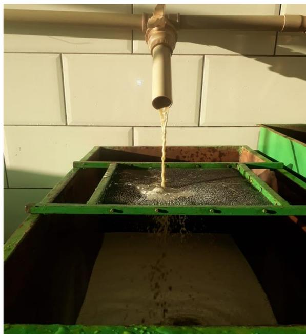
**Figura 5:** Peneira de remoção dos sólidos insolúveis.
