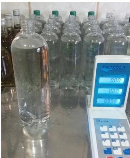
**Figura 12:** Balança digital de pesar garrafa de cachaça
