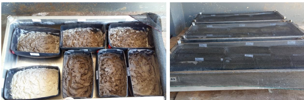
Figura 1. Reatores instalados no interior de banheiras (a) e cobertos com sombrite (b).
