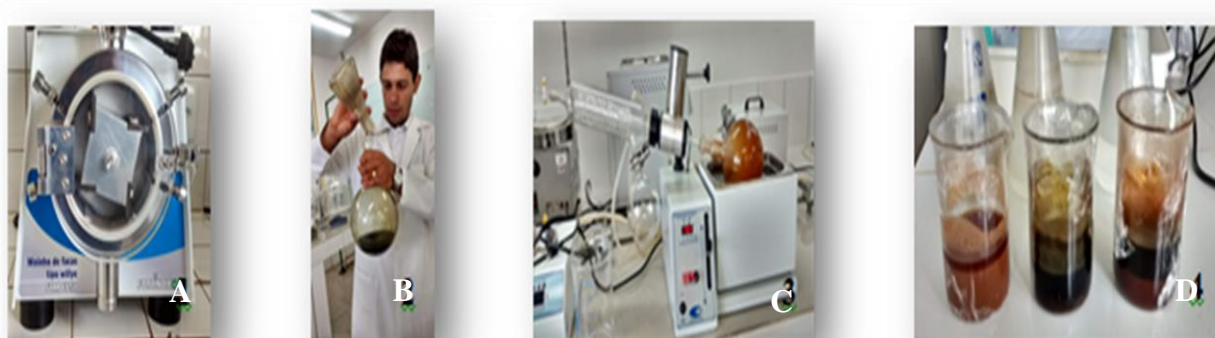
Figura 5. Preparo dos extratos etanólicos. A) Moinho de facas; B) solução sendo vertida no balão de vidrz; C) Extração no evaporador rotativo; D) Extrato etanólico. Morrinhos - GO, 2019.
