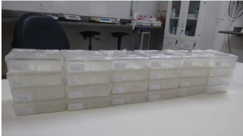
Para o teste de condutividade elétrica foram utilizadas quatro sub-amostras de 50 sementes por tratamento, pesadas em balança de precisão 0,001g e colocadas para embeber em recipientes plásticos com 75 mL de água destilada (Figura 10), à temperatura de 25°C por 24 horas. Após realizou-se a leitura em um condutivímetro da marca Digimed CD-20 com ajuste automático da temperatura e os dados expressos em  $\mu\text{S g}^{-1} \text{cm}^{-1}$  de sementes.
