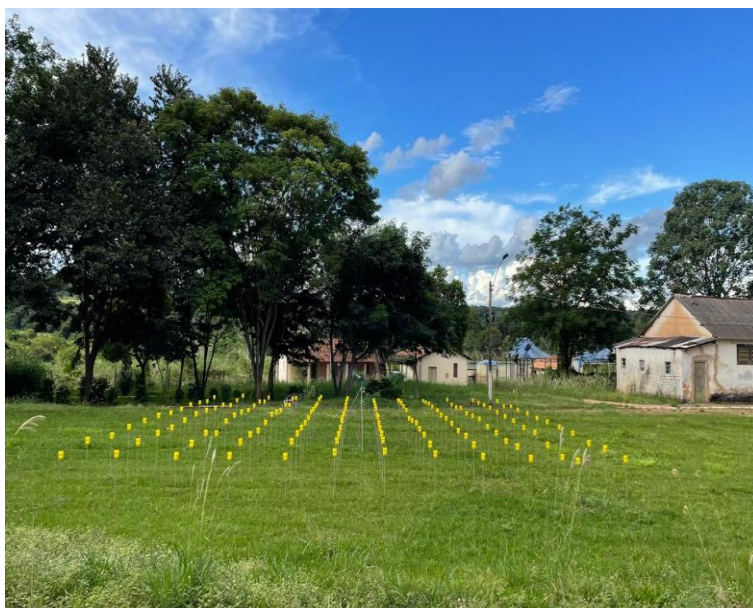
Figura 2. Aspersor e coletores montados para avaliação de Uniformidade de Distribuição de Água Fonte: Autor (2025).
