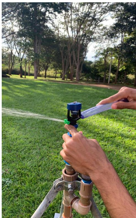
Figura 7. Realização da medição de vazão. Fonte: Autor (2025).
