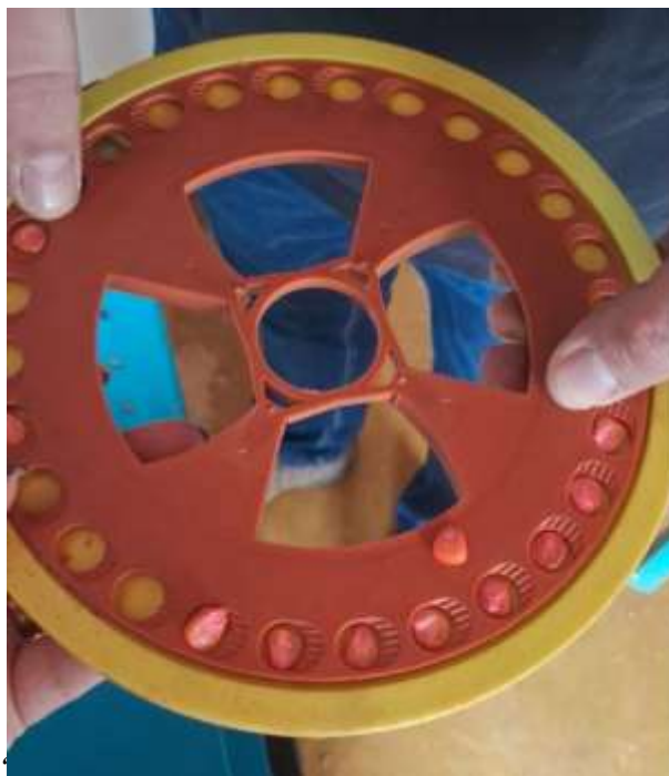
Figura 3 – Disco dosador horizontal com 28 alvéolos em fileira simples. Fonte: Autoria própria (2026).
