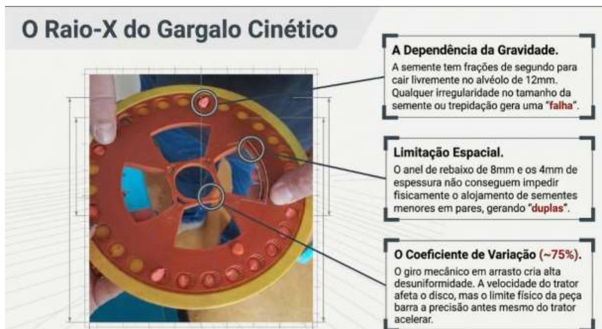
Figura 7– Representação esquemática dos gargalos cinéticos do dosador horizontal convencional, destacando dependência da gravidade, limitação espacial e elevado coeficiente de variação.
