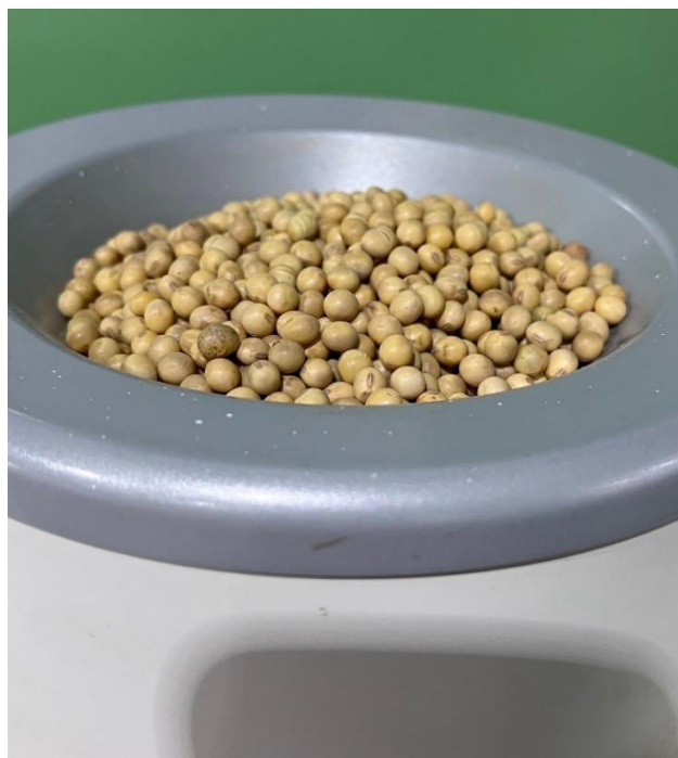
Figura 16- Inserção da semente no determinador eletrônico de umidade.
