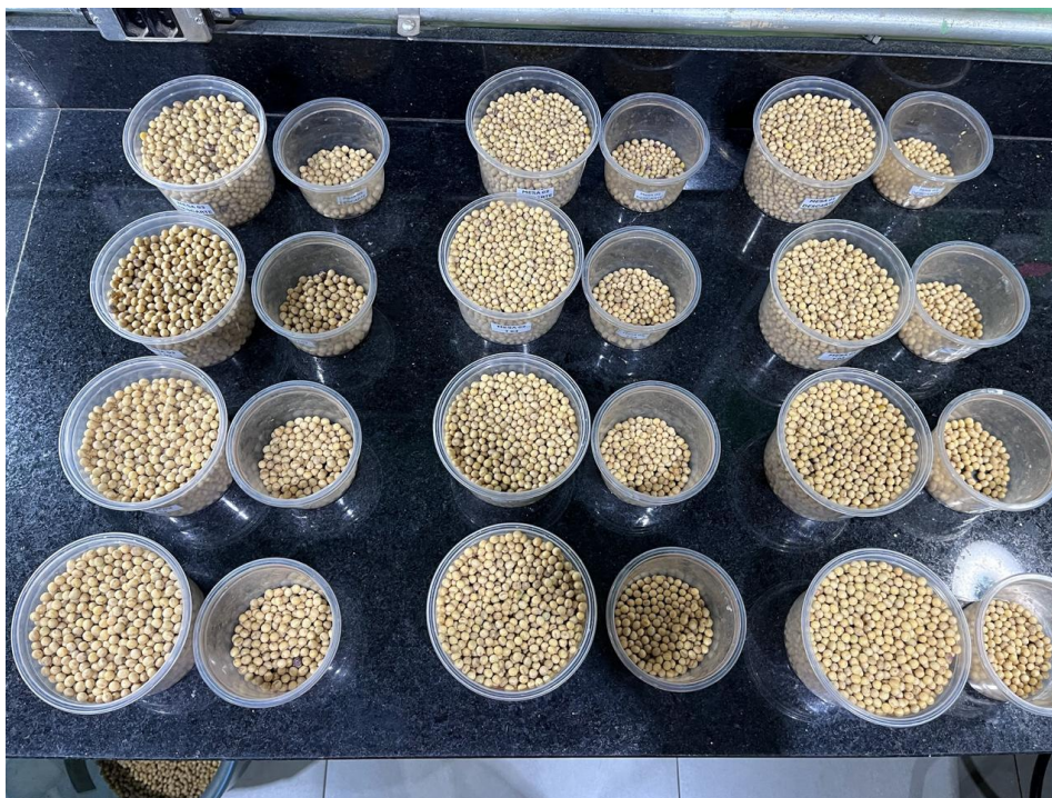
Figura 8- Amostras coletadas nas mesas densimétricas e separação de 200 semestres para análise de dano mecânico
