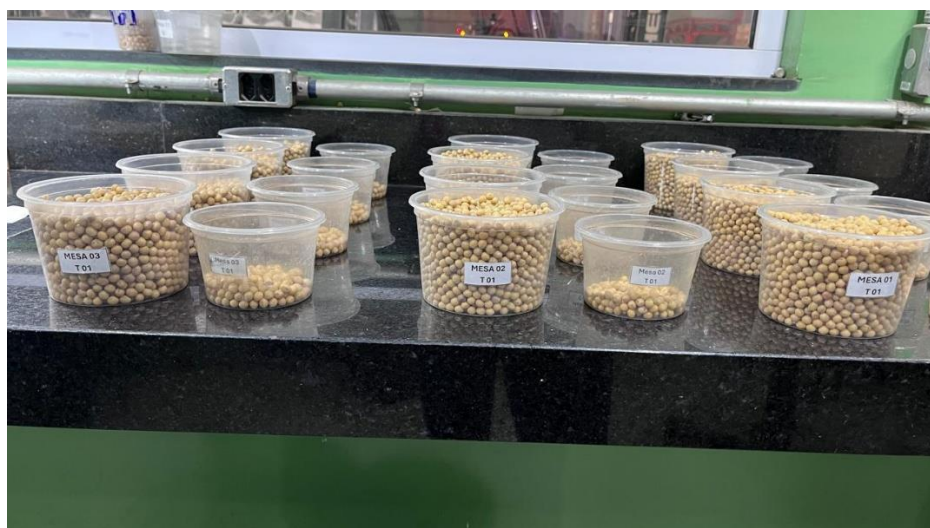
Figura 9- Amostra coletada na mesa densimétrica (esquerda) e subamostra de 200 sementes utilizada na análise de dano mecânico (direita).
