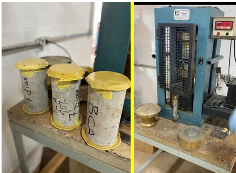
Figura 4:Corpos de prova capeados e prensa utilizada no ensaio de compressão.
