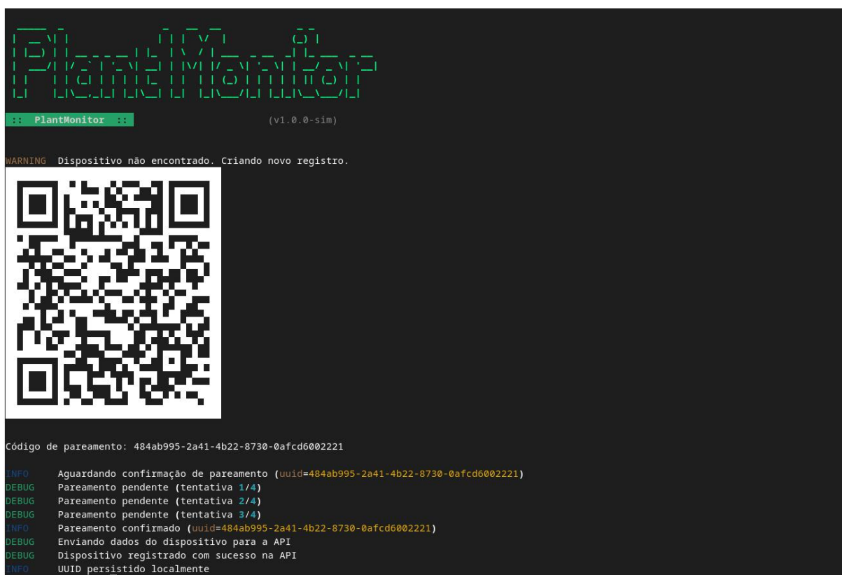
Figura 10 - Início da execução: Cadastro do Sistema Embarcado
