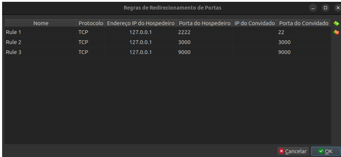
Figura 2.2: Redirecionamento de portas configurado no VirtualBox.
