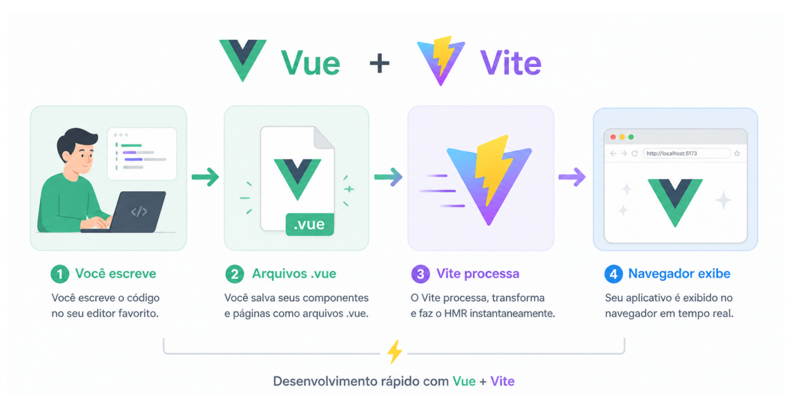
Figura 4.8: Integração Vue e Vite.
