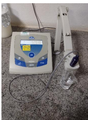
Figura 3: pHmetro de Bancada - PG2000
