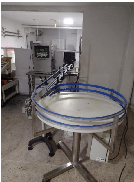
Figura 15: Esteira, Codificadora inkjet e Mesa acumuladora rotativa
