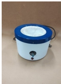
Figura 20: Manta aquecedora – Aquecimento uniforme de balões.
