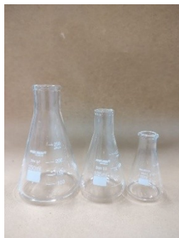
Figura 7: Erlenmeyer - Misturar soluções
