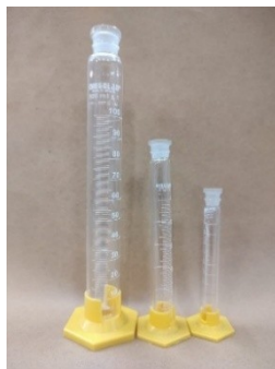
Figura 1: Proveta - Medir volumes com média precisão
