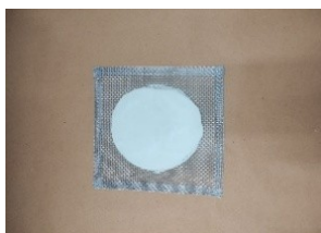
Figura 19: Tela de amianto – Distribuição da chama.
