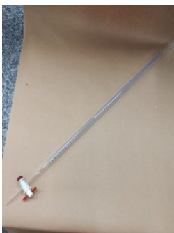
Figura 4: Bureta – Medir volumes com alta precisão em titulações.
