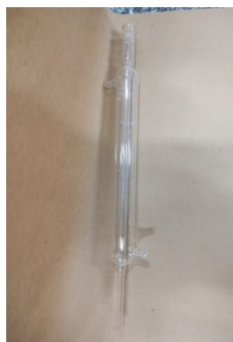
Figura 16: Condensador de Liebig – Resfriar vapores para condensá-los
