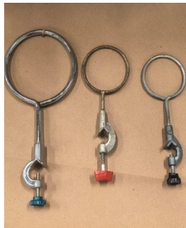
Figura 23: Argola metálica – suporte para funis ou vidrarias.
