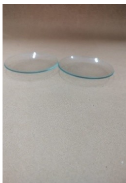
Figura 11: Vidro de relógio - Pesagem de sólidos
