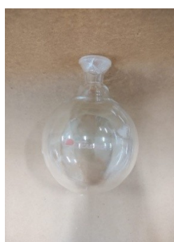
Figura 10: Balão de fundo redondo – Aquecimento ou realizações de reações
