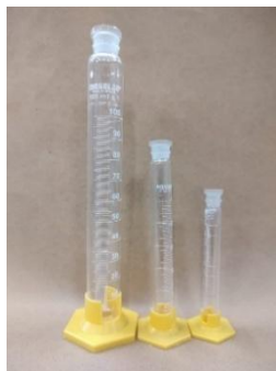
Figura 1: Proveta - Medir volumes com média precisão
