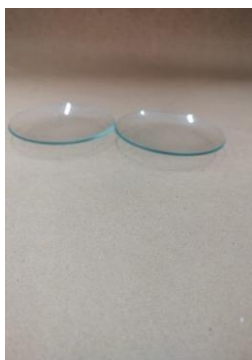
Figura 11: Vidro de relógio - Pesagem de sólidos
