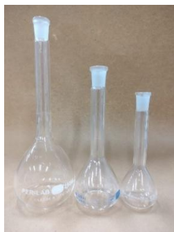
Figura 5: Balão volumétrico – Preparação de soluções com volumes fixos.
