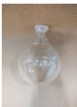
Figura 10: Balão de fundo redondo – Aquecimento ou realizações de reações
