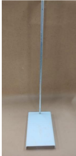
Figura 22: Suporte universal – Estrutura para prender vidrarias.
