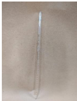
Figura 3: Pipeta graduada - Medir volumes e transferência
