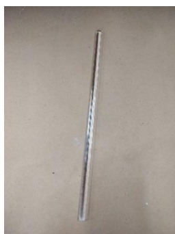
Figura 26: Bastão de vidro – Agitação de soluções
