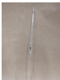
Figura 2: Pipeta Volumétrica - Transferir e medir volumes com alta precisão.
