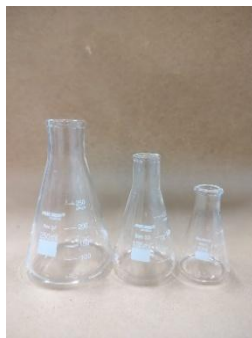
Figura 7: Erlenmeyer - Misturar soluções
