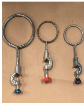
Figura 23: Argola metálica – suporte para funis ou vidrarias.
