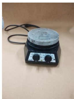
Figura 21: Chapa aquecedora / agitação magnética – aquecimento e agitação de substâncias
