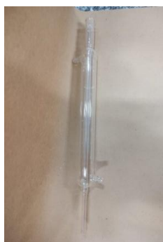
Figura 16: Condensador de Liebig – Resfriar vapores para condensá-los
