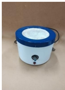
Figura 20: Manta aquecedora – Aquecimento uniforme de balões.
