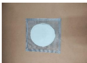
Figura 19: Tela de amianto – Distribuição da chama.
