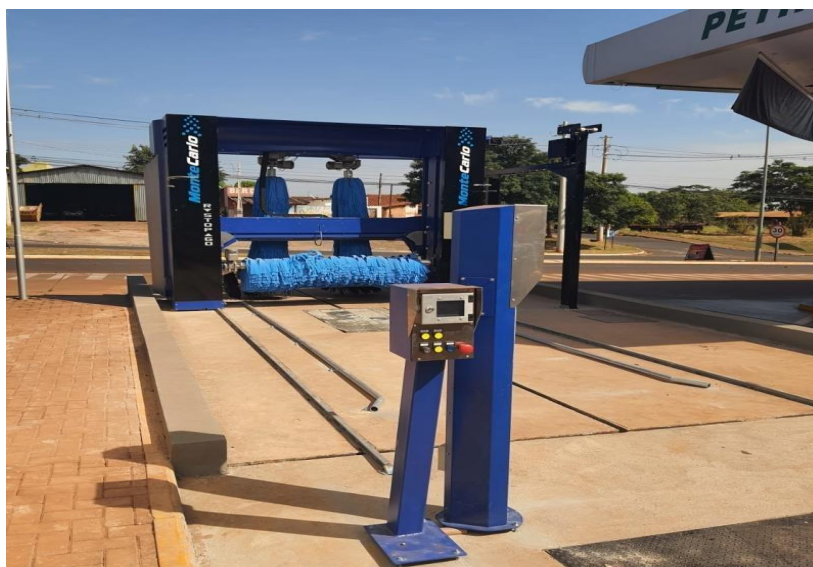
Figura 4. Imagem do processo de lavagem por Rollover.
