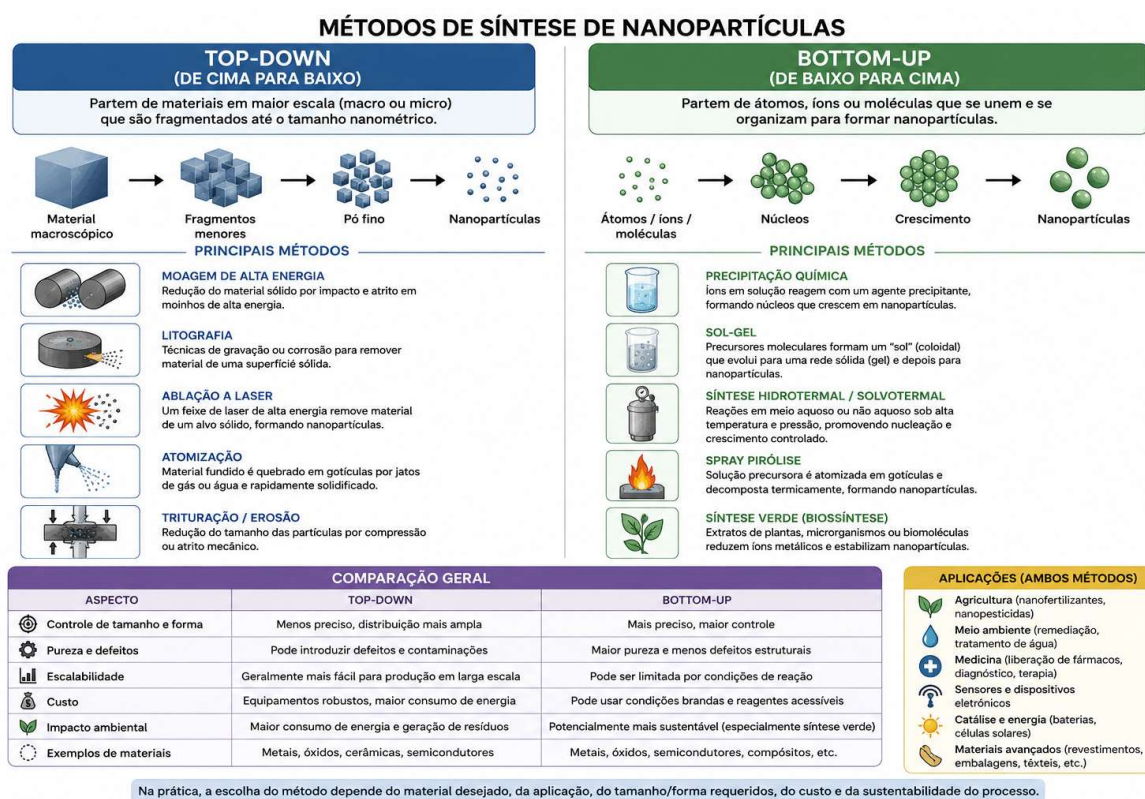
Figura 1: Esquema diferenciando métodos bottom-up e top-down
