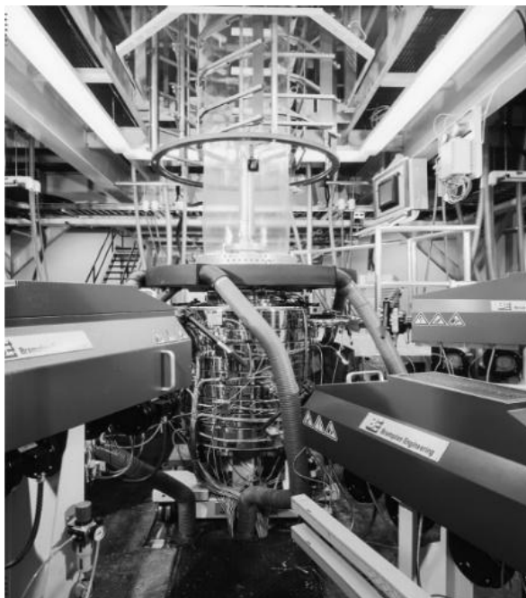
Figura 3 - Filme soprado de camada de cilindro de extrusão na formação de balão.
