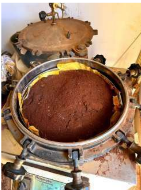
Figura 1 Autoclavagem do solo utilizado nos ensaios, visando a assepsia e a padronização das condições experimentais para avaliação de herbicidas.
