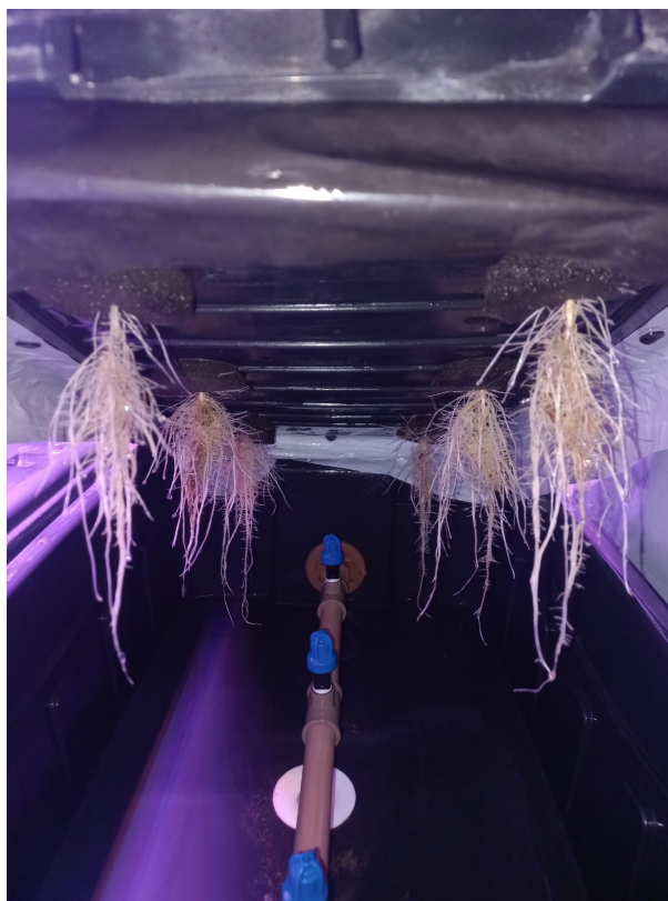
Figura 5 – Visão interna da caixa plastica adaptada com sistema de nebulização para cultivo de plantas em sistemas de aeroponia.
