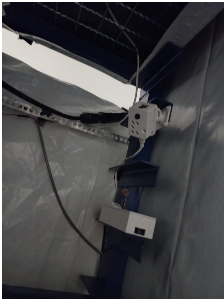
Figura 4 – Módulo ESP8266 protegido por caixa produzida por impressão 3D.
