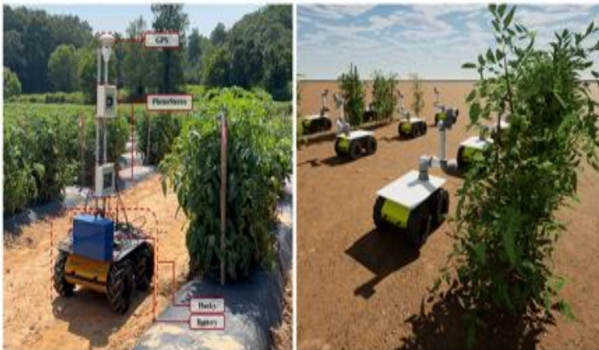
Figura 7: Sistema físico e sistema virtual utilizados no monitoramento de doenças em tomateiros
