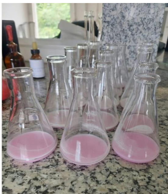
Figura 2 – Procedimento de titulação para determinação da acidez titulável.
