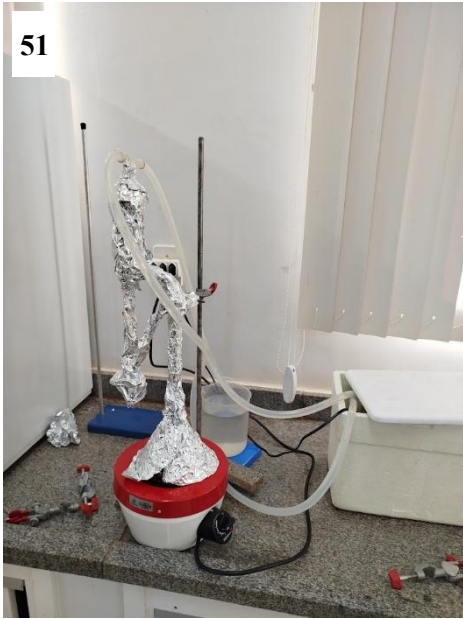
Figuras 51 e 52 – Sistema de extração revestido com papel-alumínio.
