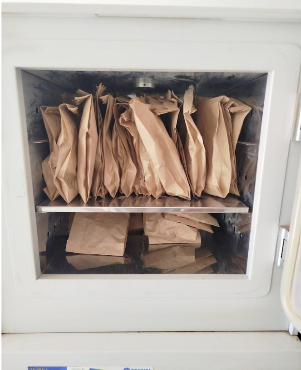
Figura 43 - Amostras sendo secadas a 65°C.
