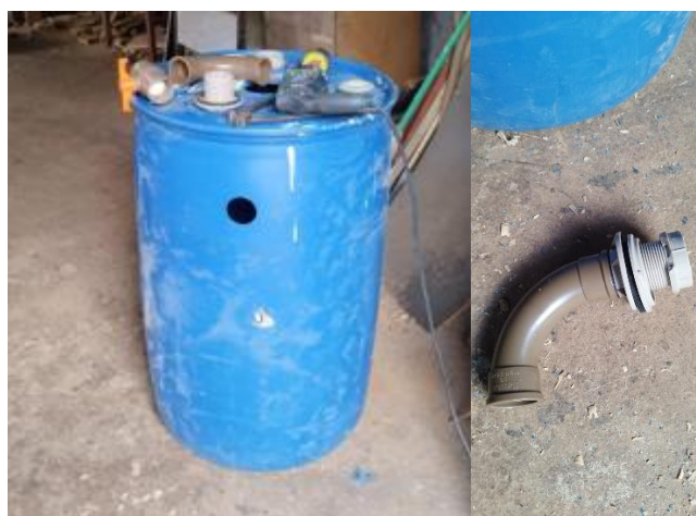
Figura 10 - Orifício para saída do biofertilizante e flange com a curva conectada
