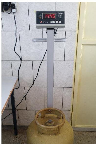
Figura 16 - Pesagem do biogás armazenado
