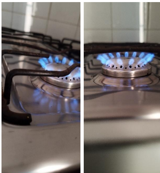
Figura 17 - Utilização do biogás em fogão adaptado
