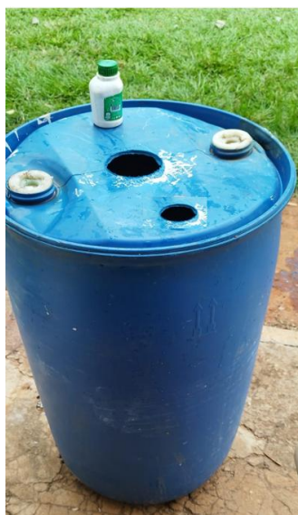
Figura 8 - Bombona plástica utilizada como reator anaeróbio
