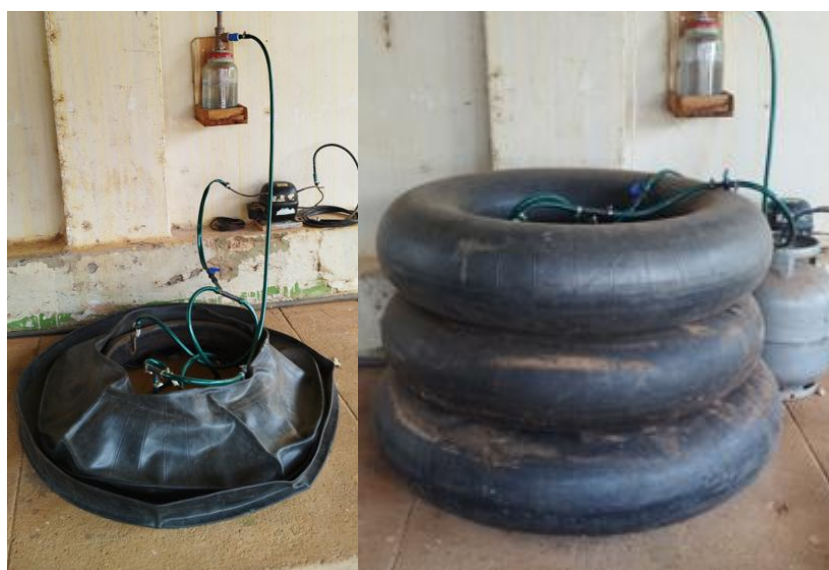
Figura 14 - Sistema de armazenamento utilizando câmaras de ar, destacando o nível de enchimento e sua integração com o sistema.
