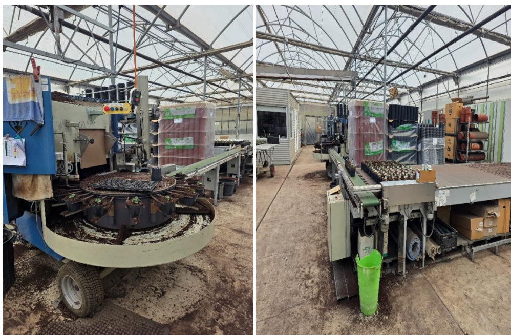
Figura 3 – Máquina para transplântio de mudas e mesa organizadora de blocos.
