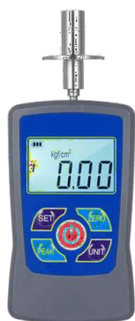
Figura 11. Penetrômetro utilizado para a firmeza dos frutos de tomate, variedade guará.
