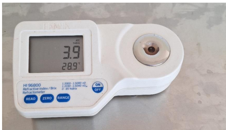
Figura 10. Refratômetro utilizado em frutos de tomate, variedade Guará para determinação de sólidos solúveis totais.
