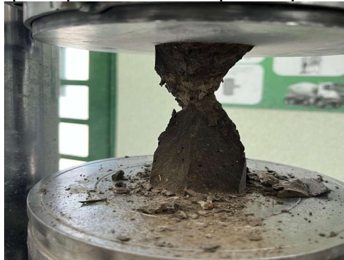
Figura 14-2 – Corpo de prova sem fibra após rompimento por compressão.
