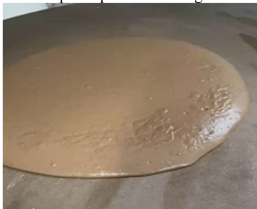
Figura 12-2 – Concreto após espalhamento segundo ASTM C1437:2020.
