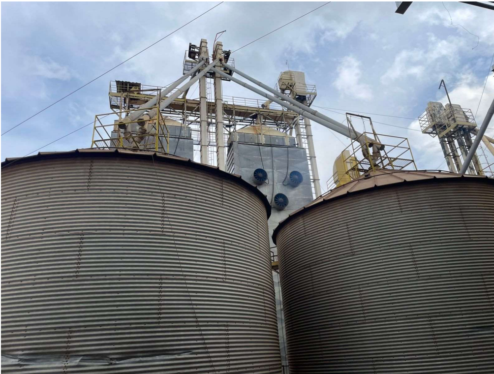
Figura 16 – Sistema de resfriamento dos grãos de soja após a secagem, antes do armazenamento Fonte: Autor (2026).
