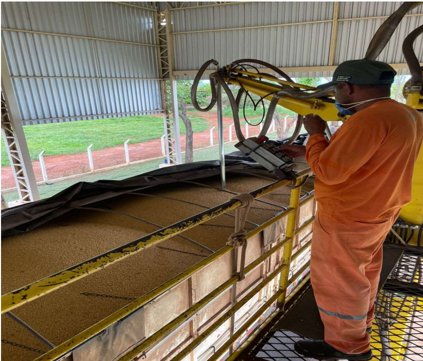
Figura 3 – Amostrador pneumático utilizado na coleta de grãos de soja no recebimento. Fonte: Autor (2026).
