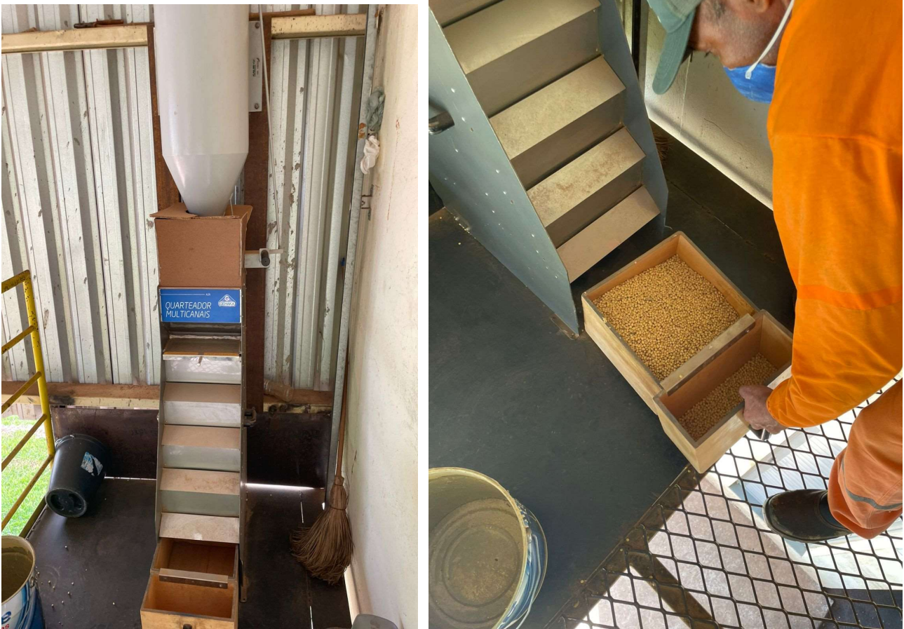
Figura 4 – Quarteador utilizado para divisão e homogeneização de amostras de grãos de soja Fonte: Autor (2026).
