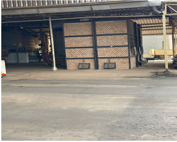
Figura 14 – Fornalha utilizada para alimentação de combustível (lenha) no sistema de secagem de grãos de soja. Fonte: Autor (2026).
