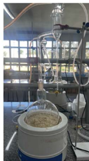
Figura 2. Etapas de extração de OE-ZO no Laboratório de Produtos Naturais do Instituto Federal Goiano – Campus Rio Verde, GO, Brasil. 1- Rizomas de Z. officinale cortados em pequenos pedaços. 2- Rizomas triturados com água para o processo de hidrodestilação. 3- Processo de extração em um aparelho de Clevenger. Fonte: Autora (2025).
