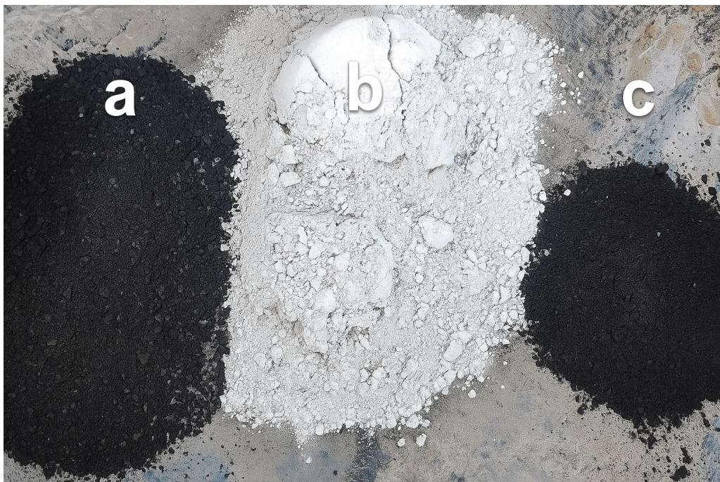
Figura 1 – Principais insumos utilizados nos traços experimentais, sendo; a) areia artificial; b) cimento Portland; c) biochar; (da esquerda para a direita).
