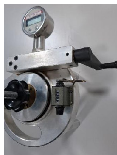
Figura 2 – Instrumentação laboratorial utilizada e finalidade, sendo: (a) Prensa manual modelo FT-02, marca Fortest, aplicada ao ensaio de compressão; (b) Aderímetro com capacidade de 1500 kgf, utilizado no ensaio de aderência.
