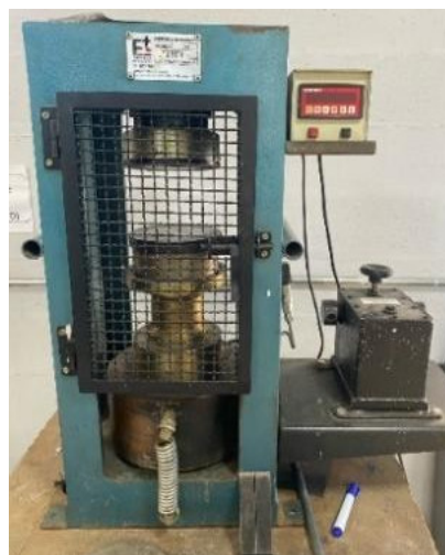
Figura 2 – Instrumentação laboratorial utilizada e finalidade, sendo: (a) Prensa manual modelo FT-02, marca Fortest, aplicada ao ensaio de compressão; (b) Aderímetro com capacidade de 1500 kgf, utilizado no ensaio de aderência.
