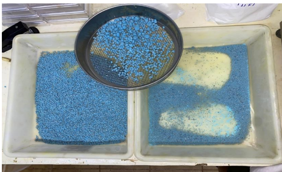
Figura 7. Amostra separada após o peneiramento (pelotas puras à esquerda, materiais inertes livres à direita e pelotas puras ao meio). Fonte: Acervo pessoal, (2025)
