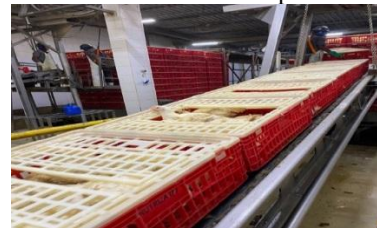
Figura 4 - Descarregamento da gaiola através de elevadores e esteiras transportadoras
