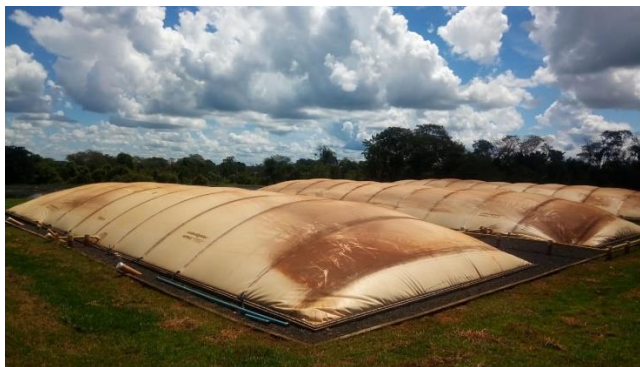
Figura 8. Exemplo de biodigestor canadense. Fonte: Autor
