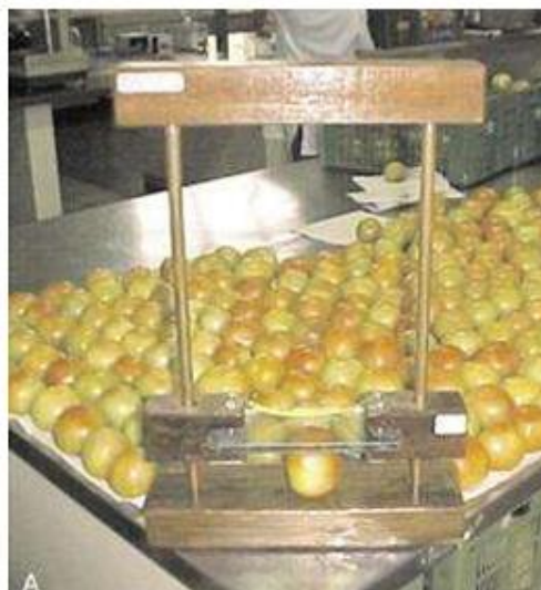
Figura 5: Aplanador para determinação da firmeza dos frutos de tomate. FONTE: Moretti (2006)
