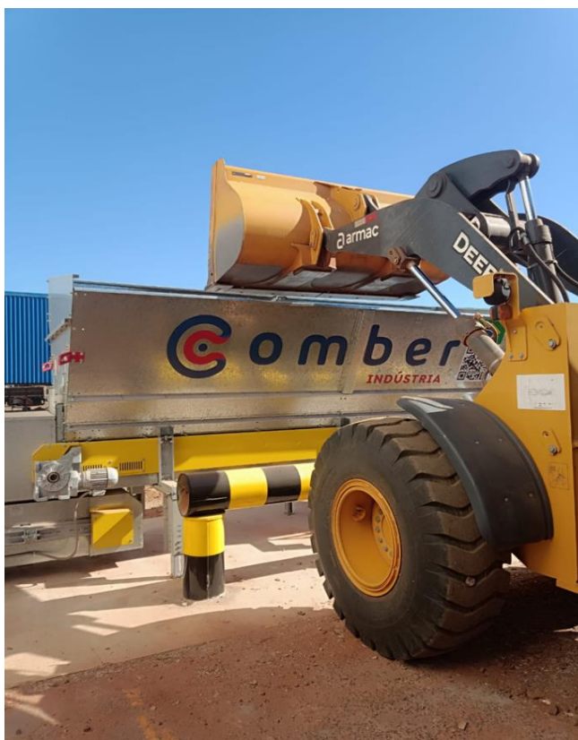
Figura 9 – Reabastecimento de cavaco na caixa de estoque com máquina
