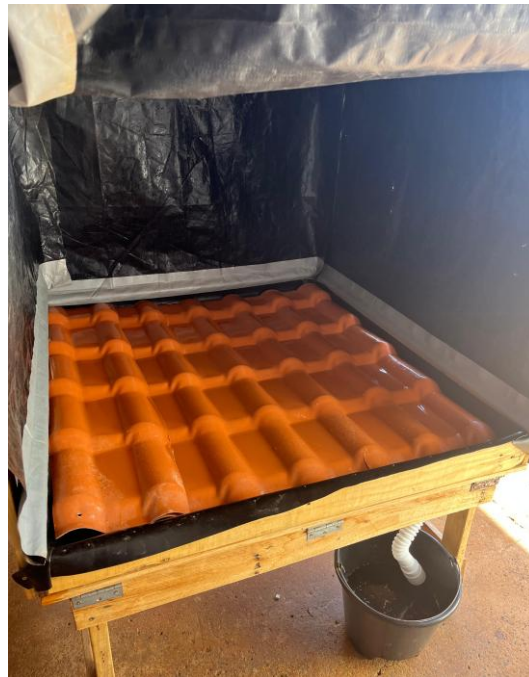
Figura 12: Módulo de cobertura convencional
