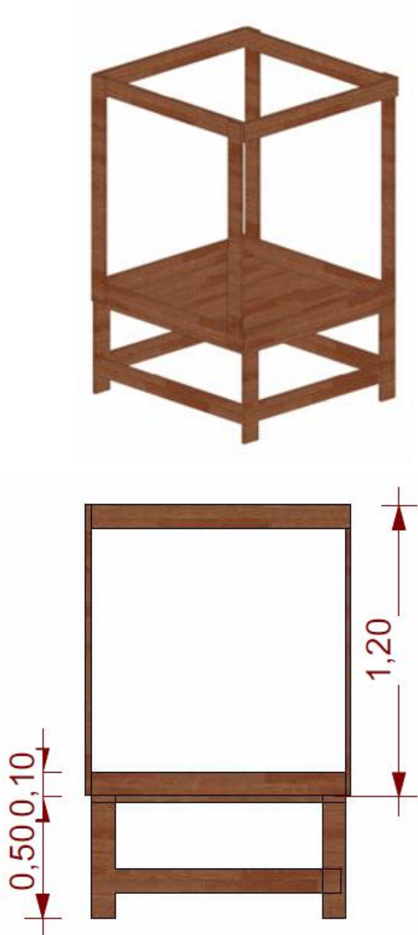
Figura 7: Perspectiva isométrica e vista lateral do módulo experimental
