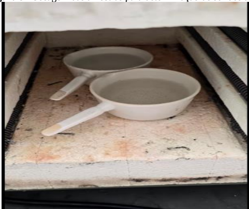
Figura 9 - Secagem das amostras para determinação de sólidos totais
