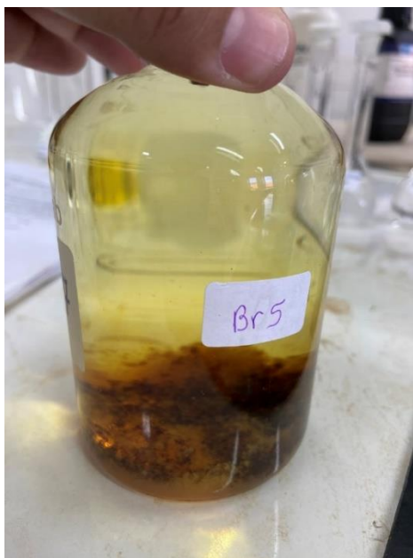
Figura 8- Amostra submetida ao ensaio de Demanda Bioquímica de Oxigênio (DBO 5 ) após período de incubação.
