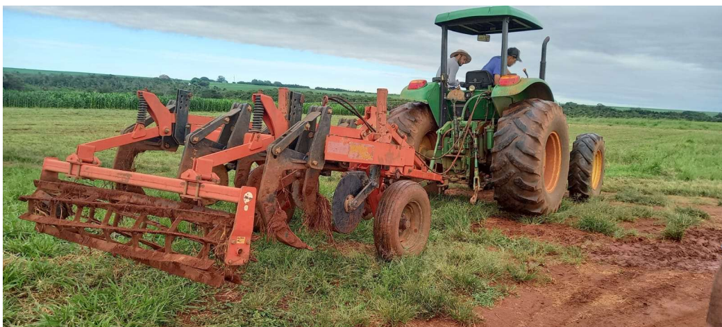
Figura 2 - Subsolador com hastes e rolo destorroador Jumbo Matic Jan.
