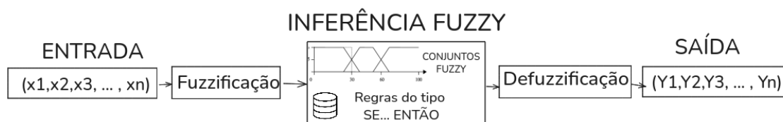
Figura 13. Desenho esquemático do modelo lógico fuzzy. Fonte: autores.
