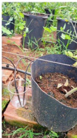
Figura B. Teste para verificar a equidade na vazão dos gotejadores.
