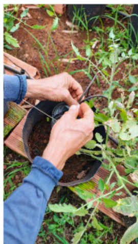
Figura B. Teste para verificar a equidade na vazão dos gotejadores.
