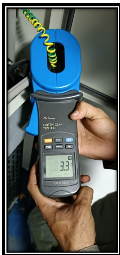
Figura 46 - Testes de aferição de aterramento do painel – A
