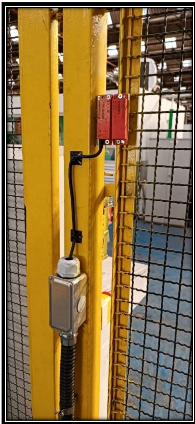
Figura 37 - Proteções moveis – A
