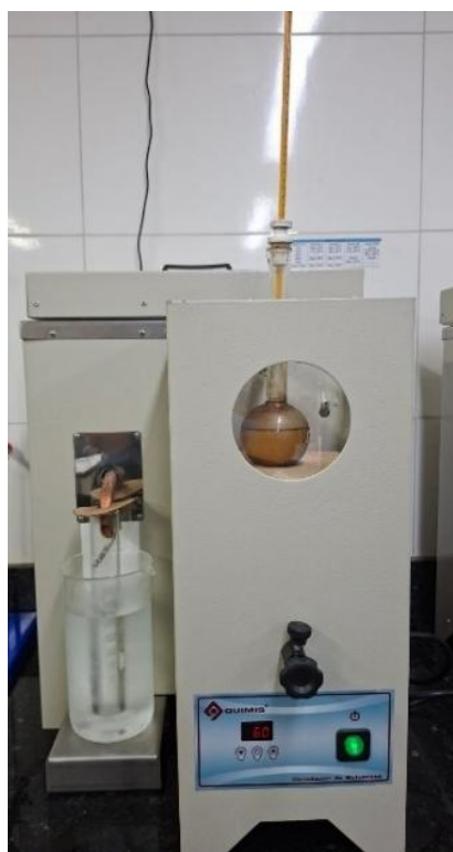
Figura 11 – Equipamento para realizar o processo de destilação da gasolina A do tanque de armazenamento do Terminal
