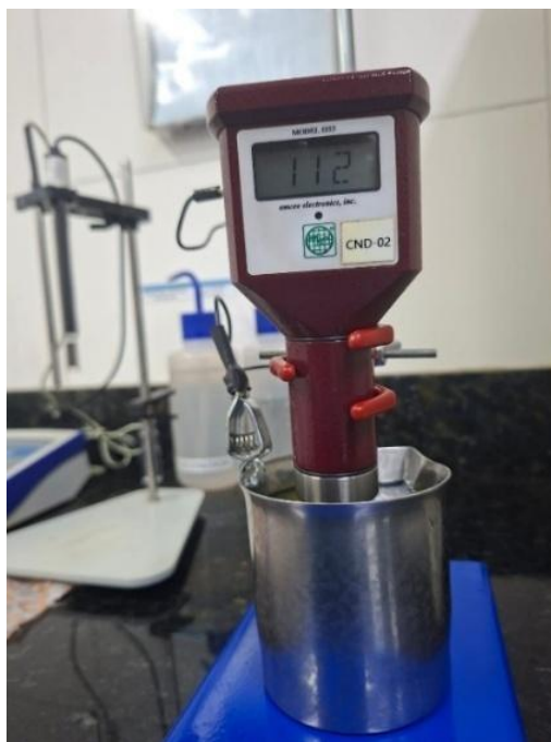
Figura 17 – Análise da condutividade do S10A para controle de qualidade do tanque de armazenamento
