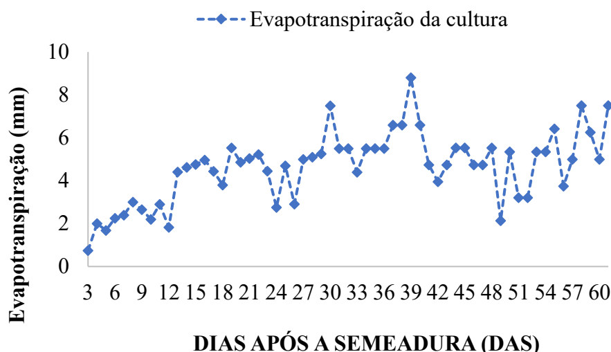
Figura 2 –Evapotranspiração da cultura obtida a partir Eto calculada pelo método do Tanque Classe A, instalado no interior da casa de vegetação. Fonte: Arquivo pessoal (2023).
